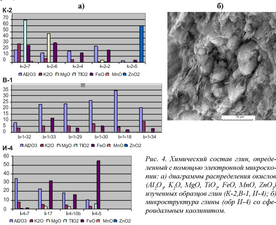
Рис. 4. Химический состав глин, определенный с помощью электронной микроскопии: а) диаграммы распределения окислов ( $Al_2O_3$ ,  $K_2O$ ,  $MgO$ ,  $TiO_2$ ,  $FeO$ ,  $MnO$ ,  $ZnO_2$ ) изученных образцов глин (K-2, B-1, I-4); б) микроструктура глины (обр I-4) со сфероидальным каолинитом.
